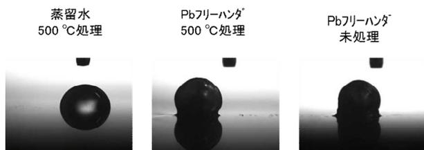
図4 大気酸化処理試料表面の液滴の様子
